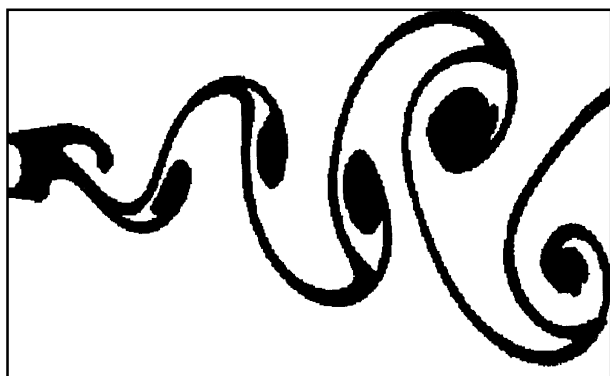
Рис. 5. Изображение после заполнения замкнутых областей внутри вихря
