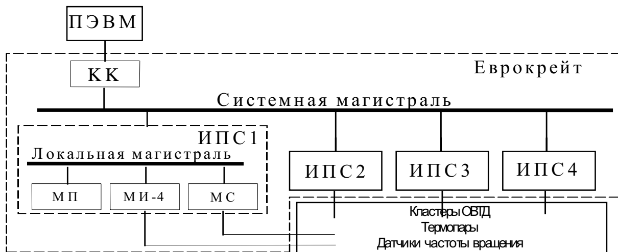
Рис.3. Структура одной из наиболее представительных и современных систем – СИ-03-М
