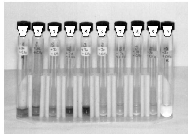
**Рис. 4.** Восстановление  $\text{Fe(III)}$  пирофосфата штаммом *Shewanella putrefaciens*: 1 – контроль без бактерий +  $\text{Fe(III)} + \text{CH}_4$ ; 2,3 – бактерии +  $\text{Fe(III)} + \text{CH}_4$ ; 4,5 – бактерии +  $\text{Fe(III)} - \text{CH}_4$ ; 6,7 – бактерии –  $\text{Fe(III)} + \text{CH}_4$ ; 8,9 – бактерии –  $\text{Fe(III)} - \text{CH}_4$ ; 0 – контроль без бактерий –  $\text{Fe(III)} + \text{CH}_4$
