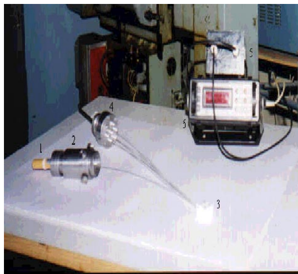
Рис. 1. Детализировка узлов экспериментальной установки для лазерной диагностики состояния биологических объектов
