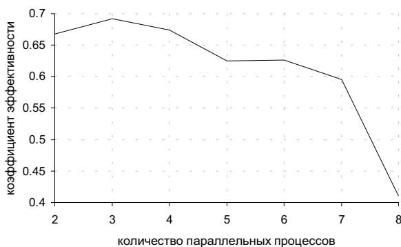
Рис. 4. Зависимость эффективности программы от числа процессов для явной разностной схемы
