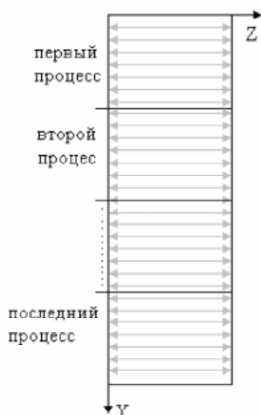
Рис. 5. Разбиение сеточной области при N_z < N_y
