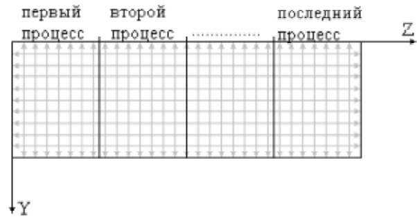
Рис. 10. Разбиение сеточной области для минимизации пересылок в случае неявной схемы
