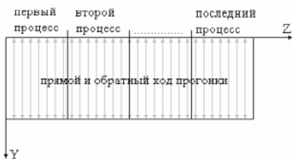
Рис. 6. Разбиение сеточной области при N_z > N_y
