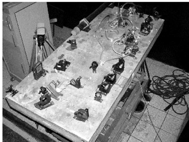
**Рис. 9.** Экспериментальный образец двухимпульсного лазера
