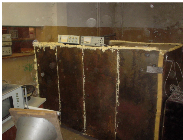
Рис. 3. Емкость, имитирующая пассажирский салон и измерительная аппаратура
