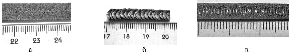
Рис. 1. Внешний вид спеченных образцов: а – с ровной поверхностью; б – “чешуйчатые”; в – с оплавлением
