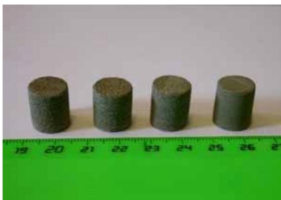
**Рис. 1.** Общий вид однородных по высоте фильтрующих элементов. Слева направо: 1 – размер фракции 63...100 мкм, высота приращения по слоям  $h = 200$  мкм; 2 – 100...160,  $h = 200$  мкм; 3 – 63...100,  $h = 100$  мкм; 4 – <50 мкм,  $h = 200$  мкм.
