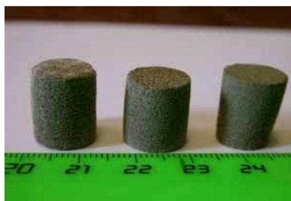
**Рис. 2.** Общий вид неоднородных по высоте фильтрующих элементов. Слева направо: 1 – 63...100,  $h = 200$  мкм, (9 вертикальных цилиндрических каналов, видны как "белесые" пятна на поверхности); 2 – 63...100 = const, изменялась –  $h = 100, 150, 200, 250, 300$ , по 3мм; 3) - изменялся размер <50, 50...63, 63...100, 100...160 мкм по 4 мм,  $h = 200$  мкм = const
