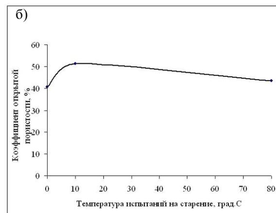
Рис. 4. Зависимость плотности (а) и коэффициента открытой пористости (б) образцов МПК–3,5 от температурного режима старения
