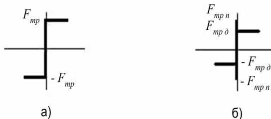
Рис. 2. Модели силы сухого трения: а - модель трения в виде релейной характеристики; б - модель с учетом трения покоя и трения движения
