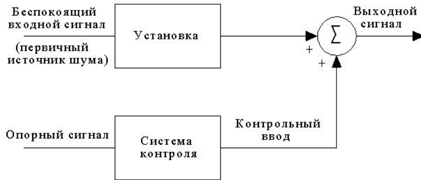
Рис. 7. Неадаптивная переднесвязанная система компенсации
