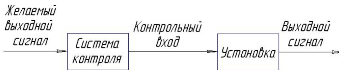
Рис. 5. Адаптивная разомкнутая система компенсации
