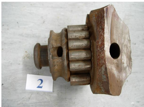
Рис. 2. Заклиненная опора бурового горнорудного долота
