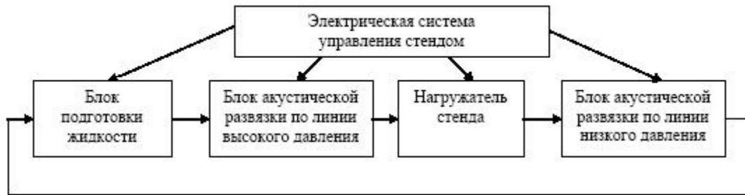
Рис. 3. Функциональная схема гидравлической системы нагружения
