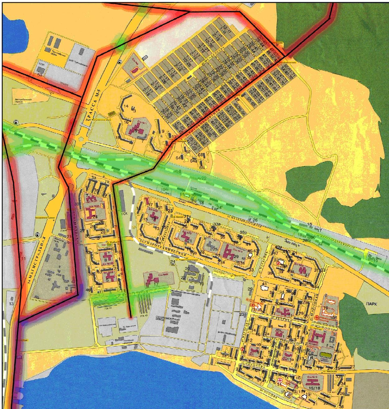
**Рис. 4.** Карта электромагнитных полей диапазона промышленной частоты (электрическая составляющая  $E$ ) территории пос. Шлюзового Тольятти
