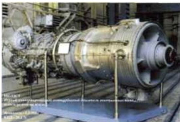
Рис. 1. Конвертированный газотурбинный авиационный двигатель НК-12СТ
