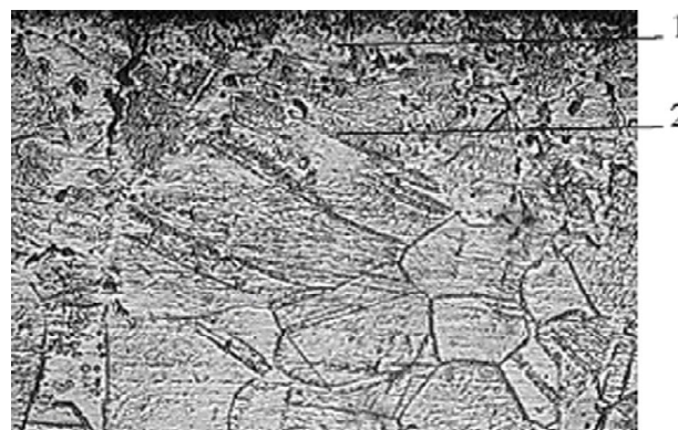
Рис. 2. Микроструктура приповерхностного слоя образца из сплава Л63 после лазерного воздействия (увеличение x1000): 1 – нанопористый слой; 2 – исходная структура
