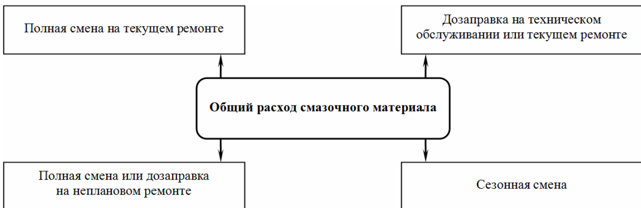
Рис. 1. Схема расхода смазочных материалов
