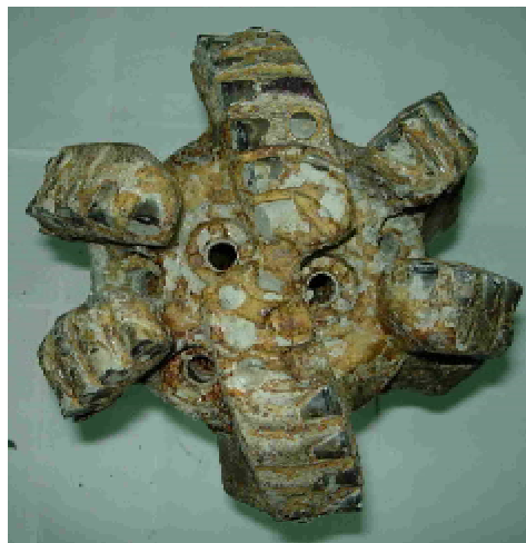
Рис. 2. Отработанное алмазное долото
