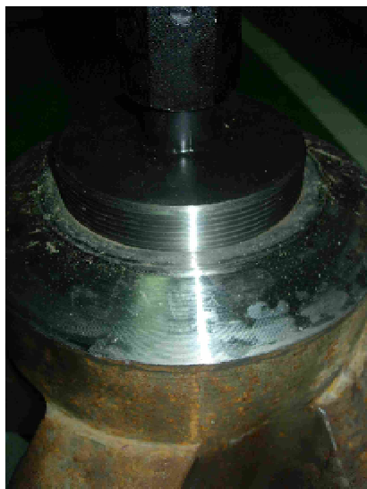
Рис. 3. Разрезанный после сварки корпус долота буровиком траектории.
