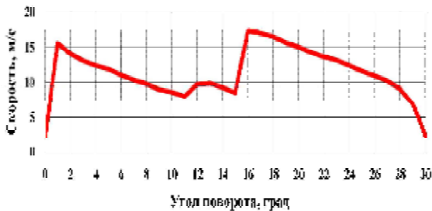
Рис. 6. Изменение требуемой из условия неразрывности потока скорости во внешнем сечении V_1
