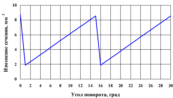
Рис. 4. Изменение площади внешнего сечения F_1 в зависимости от угла поворота ведущей шестерни \varphi_B
