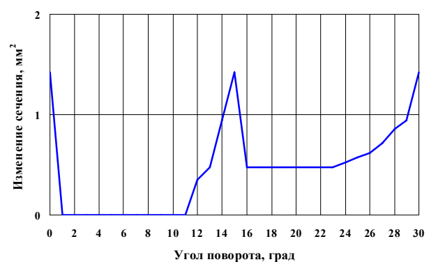
Рис. 5. Изменение площади промежуточного сечения F_2 в зависимости от угла поворота ведущей шестерни \varphi_B
