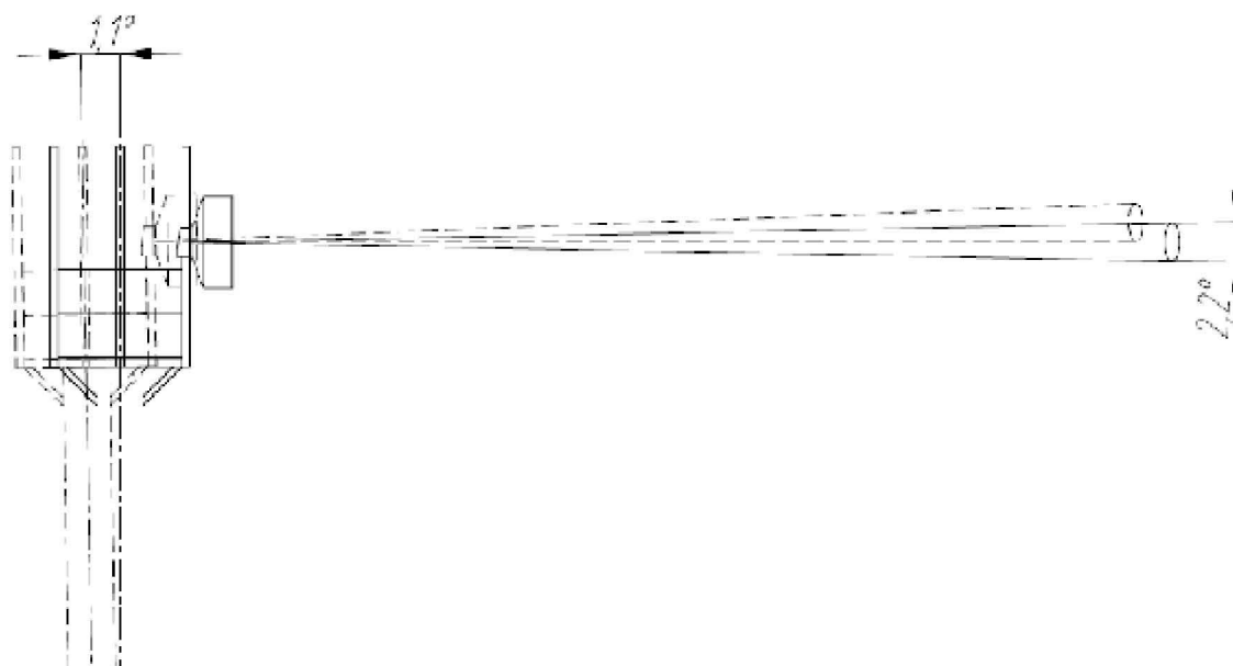
Рис. 1. Допустимый угол отклонения опоры с антенной RFS III,2м
