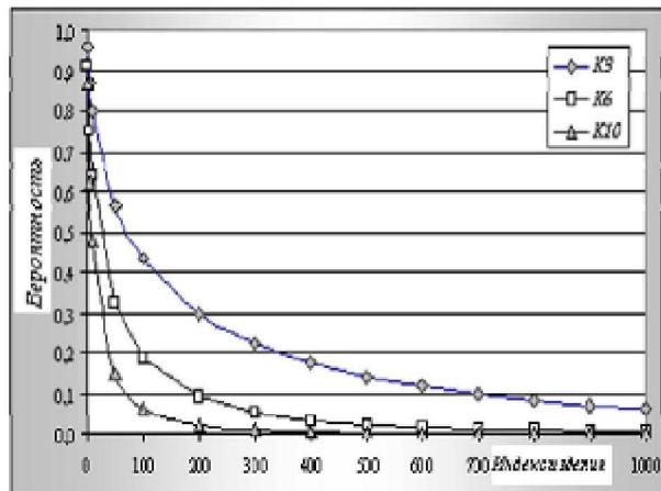
**Рис. 2.** Вероятность сжатия цикла изготовления изделия в зависимости от темпа роста производительности труда
