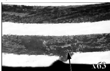
Разрушение композитного слоя и наружного слоя
