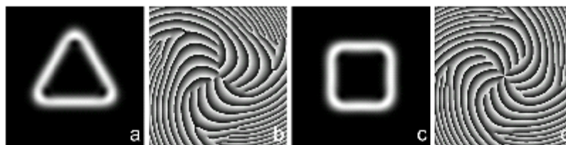
Рис. 2. Распределение интенсивности и фазы спиральных пучков в форме треугольника (a, b) и квадрата (c, d)
