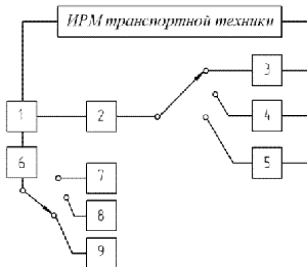
Рис. 1. Обобщенная структурная схема основных типов ИРМ транспортной техники: 1 – рычажно-шарнирное звено; 2 – коммутирующее звено; 3 – упругое звено; 4 – упругодемпфирующее (диссипативное) звено; 5 – виброизолирующее звено; 6 – выходное звено; 7 – исполнительный орган (ИО) клапанного агрегата; 8 – ИО демпфера или виброизолятора; 9 – ИО аппаратуры сигнализации, контроля или диагностики
