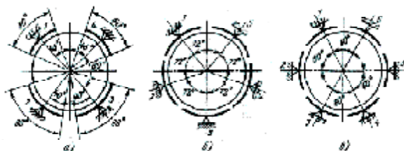
Рис. 2. Схемы подшипников с самоустанавливающимися вкладышами а – с четырьмя вкладышами; б – с пятью вкладышами; в – с шестью вкладышами
