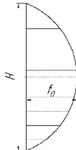
**Рис. 4.** График распределения значений коэффициента трения по высоте балки
