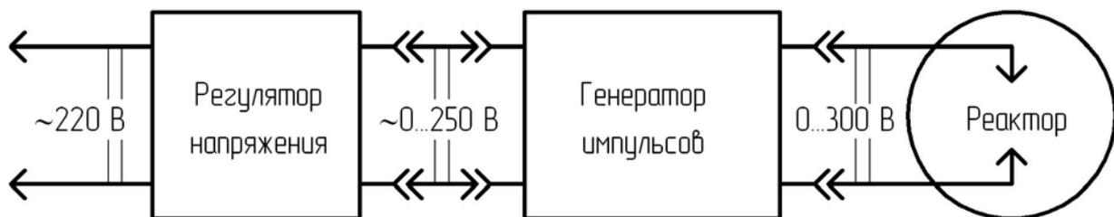
Рис. 1. Структурная схема установки ЭЭД
