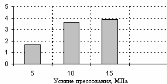
Рис. 2. Зависимость предела прочности при сжатии от давления прессования
