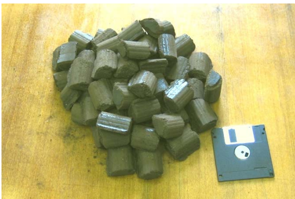
Рис. 1. Бурогольные брикеты роторного пресса
