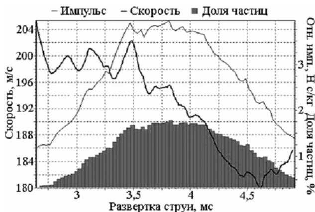
Рис. 3. Распределения скорости, относительной массы и импульса порошка в потоке за один цикл напыления
