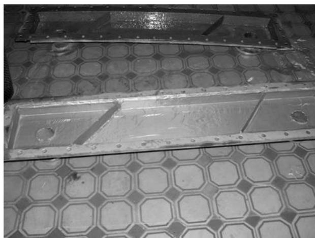
Рис. 3. Поверхность после нанесения защитного покрытия
