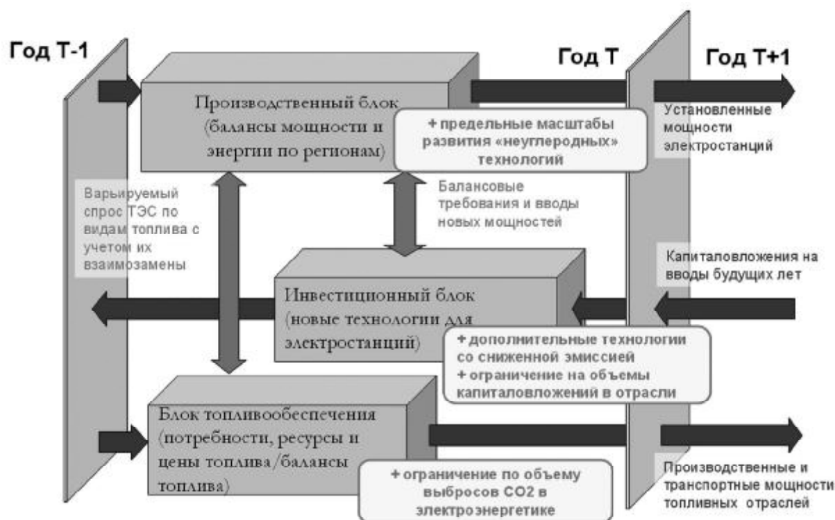
Рис. 4. Структурная схема статического блока модели оптимизации развития электроэнергетики в ТЭС с учетом ограничения эмиссии CO 2 (EPOS-CARBON)
