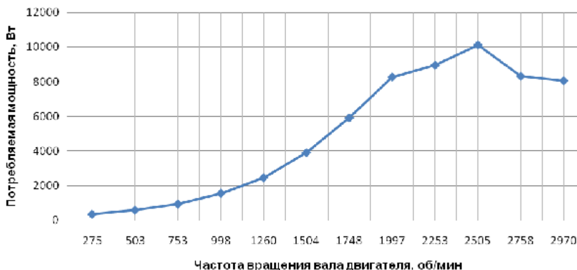
Рис. 2. Зависимость мощности двигателя кавитационной установки от частоты вращения
