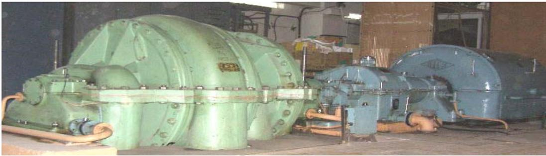
**Рис. 1.** Четырехступенчатый центробежный компрессор типа К-500-61-1 лаборатории турбостроения СПбГПУ с двумя промежуточными холодильниками
