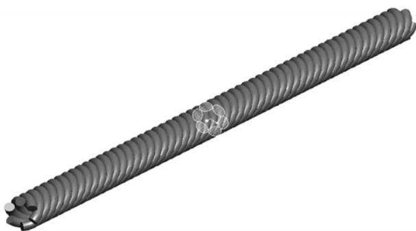
Рис. 3. Слой проволок каната линейного касания
