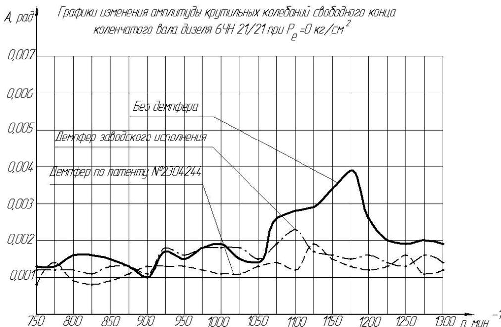
**Рис. 5.** Графики изменения крутильных колебаний свободного конца коленчатого вала дизеля 6ЧН 21/21
