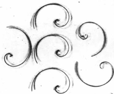
Рис. 3. Типичная форма стружки при прерывистом резании
