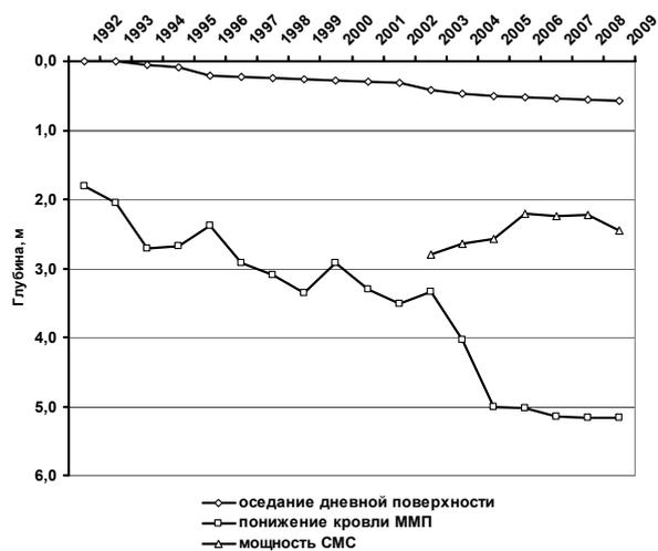
**Рис. 1.** Динамика осадки поверхности почвы и понижение кровли пород ледового комплекса на Майинском научно-экспериментальном стационаре ИМЗ СО РАН (Центральная Якутия)
