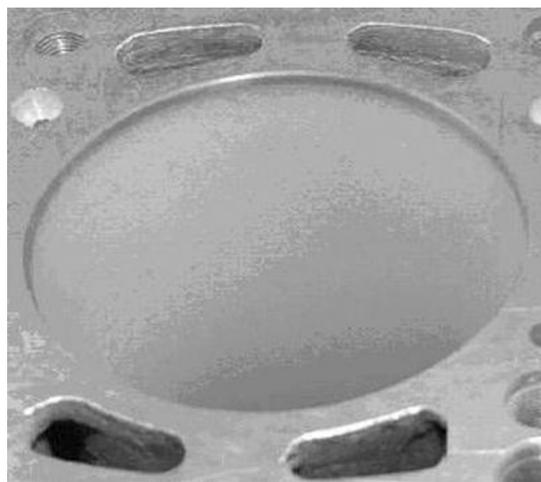
Рис. 2. Прототип алюминиевого блока цилиндров из сплава АК6М2 с МДО рабочей поверхности цилиндров
