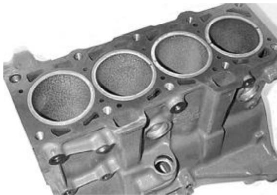
Рис. 1. Экспериментальный блок цилиндров на базе ВАЗ 21083
