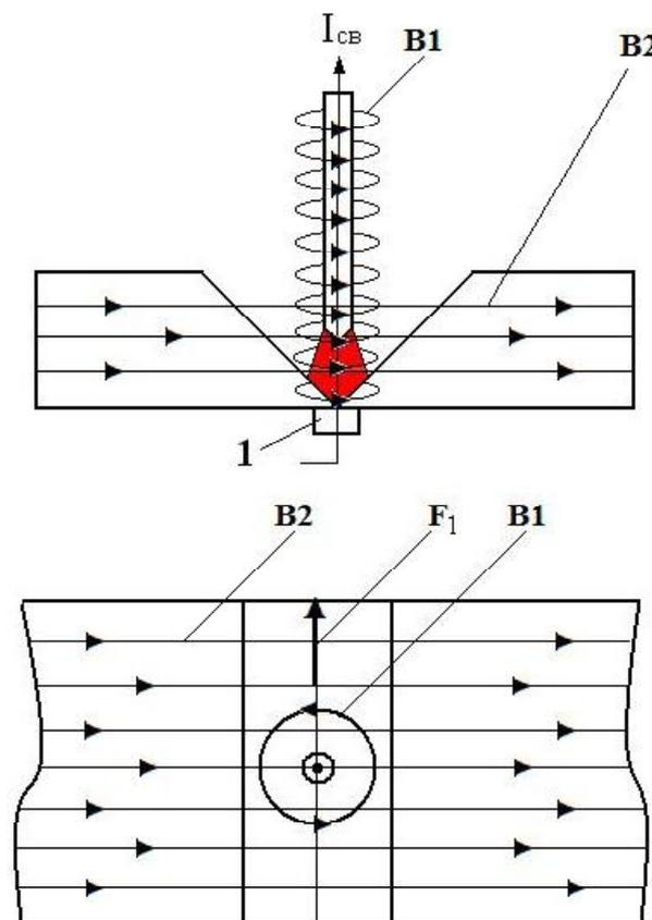
**Рис. 1.** Схема возникновения эффекта магнитного дутья, при взаимодействии собственного магнитного поля дуги ( $B_1$ ) и магнитного поля изделия ( $B_2$ ):
