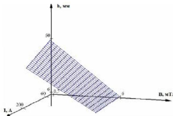
**Рис. 7.** Зависимость расстояния ( $h$ ) от оси электрода до токоподвода, при котором удаётся стабилизировать пространственное положение дуги по центру стыка, при воздействии на неё внешнего магнитного поля индукцией  $B$ , и при силе тока в сварочной цепи  $I_{св}$
