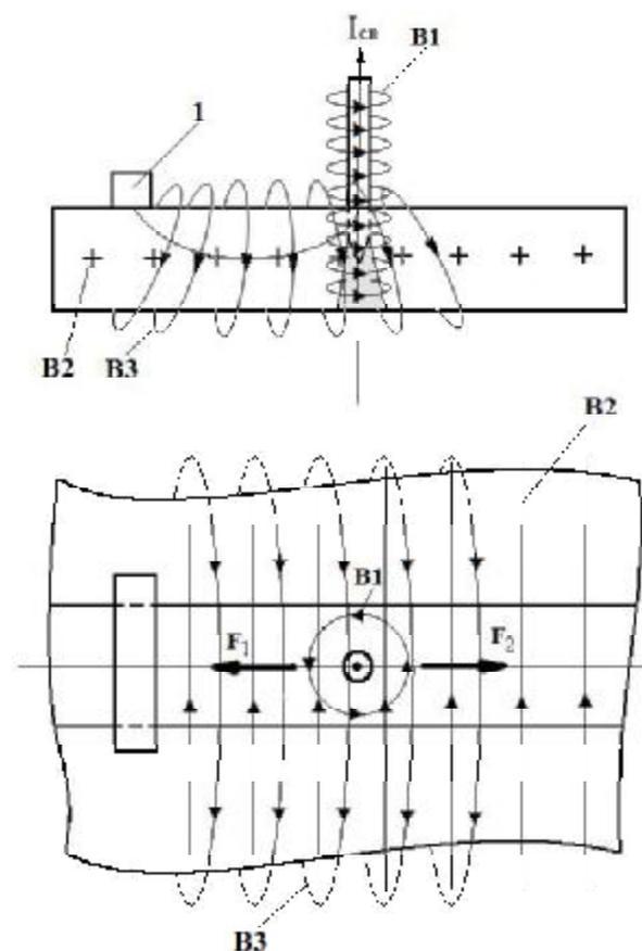
**Рис. 2.** Схема компенсации магнитного дутья с помощью магнитного поля тока, протекающего по изделию (B3):
