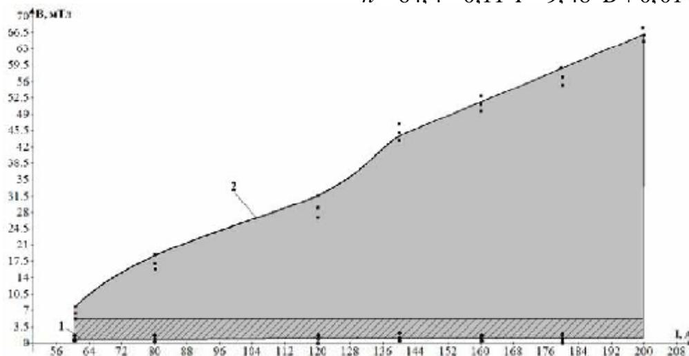
**Рис. 6.** Область, в пределах которой наблюдается воздействие внешнего магнитного поля на сварочную дугу:
