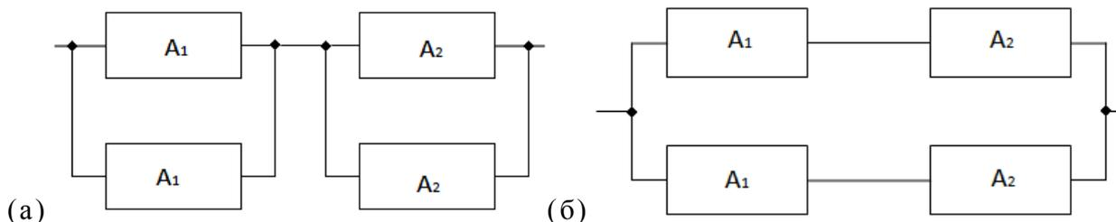
Рис. 3. Две схемы структурных соединений компонент рабочих мест исполнителей
