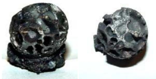
**Рис. 5.** Слитки, получаемые при сжигании гранулированной на основе нитроцеллюлозы термитной смеси с поджиганием снизу
