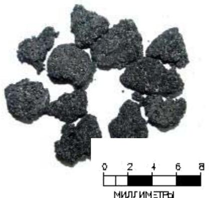
**Рис. 3.** Гранулы термитной смеси
