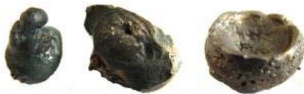
**Рис. 1.** Примеры слитков термитной стали, получаемых при сжигании непрессованных порошковых смесей малой массы в кварцевой трубке при зажигании сверху
