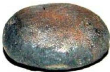
**Рис. 6.** Слиток, полученный при сжигании гранулированной на основе нитроцеллюлозы с добавлением фторкаучука термитной смеси с поджиганием снизу
