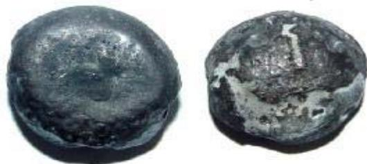
**Рис. 8.** Слитки термитного металла, полученного в результате горения термитной смеси с добавлением флюса Nocolok 1% масс
