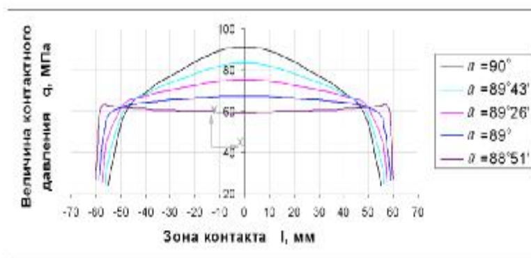
Рис. 8. Распределение нормального давления по заготовке при различных углах конусности эластичной матрицы (при технологических параметрах процесса: d=100 мм; H=10 мм; h=3.3 мм; r=1 мм; \Delta z=0,3 мм; f=0,3 ; \varepsilon =35\% )
