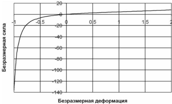
**Рис. 10.** График нагрузочной характеристики демпфера в безразмерном виде
