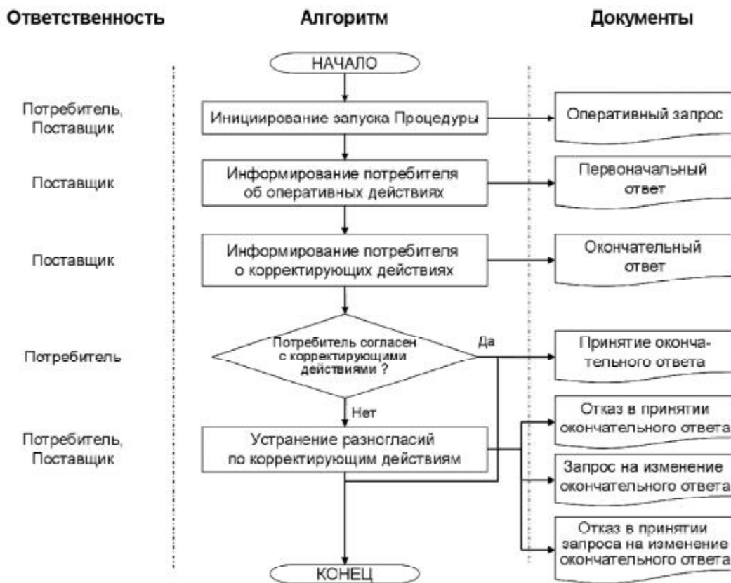
Рис. 1. Схема Процедуры реагирования поставщика на выявленные несоответствия
