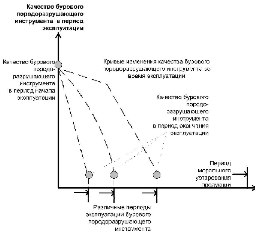
Рис. 3. Изменение качества бурового породоразрушающего инструмента во время эксплуатации
