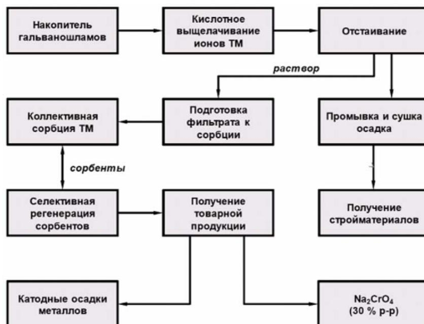
Рис. 1. Схема переработки гальваношламов
