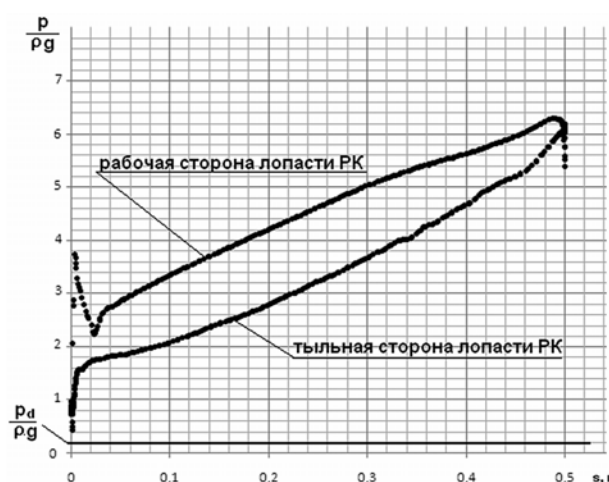
Рис. 1. Эпюра распределения давления вдоль контура лопасти в произвольном сечении
