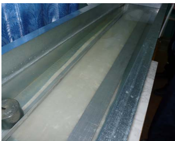
Рис. 2. Общий вид макета траншейного перехода нефтепровода
