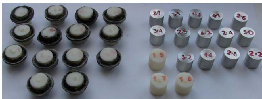
Рис. 4. Фотография изготовленных армирующих элементов и образцов
